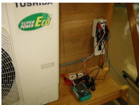
電圧、電流、消費電力の測定
