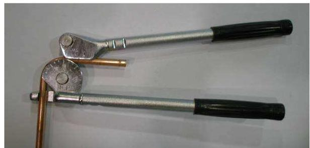
写真 5-4 ベンダーでの曲げ加工
