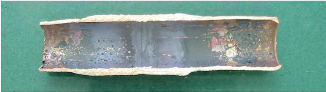
写真 5-5 窒素置換を行わない時の内部
