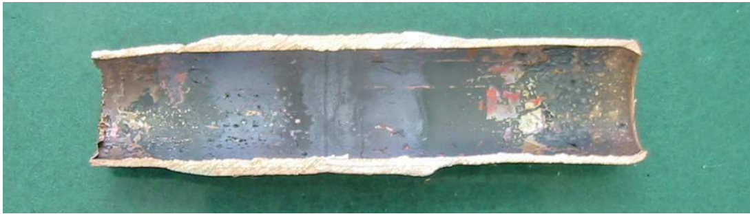
写真 5-5 窒素ブローを行わない時の内部
