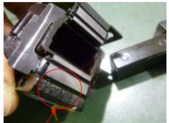
プランジヤ（可動鉄心）を吸引する際にゴミを挟むと「うなり」が発生します。
