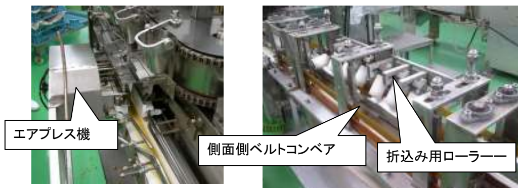
袋封入行程(左、エアプレス機 / 右、折込み用ローラー部)
