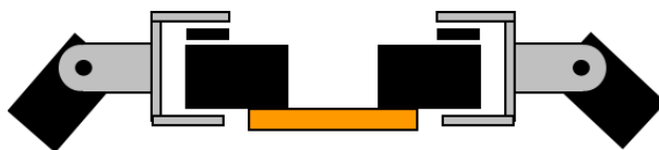
図 15.2 亀型ロボットのサーボモータ配置 前から見た図
