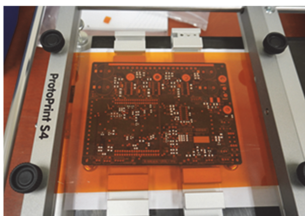
図3 クリームはんだ印刷機 ProtoPrint S4
