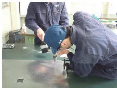
図 13 組立作業の様子(穴の調整)
