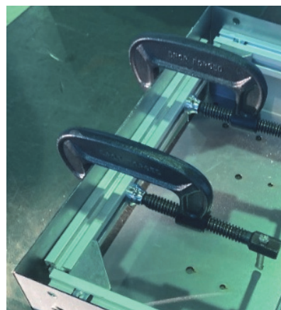
図8 アルミフレーム等による母材の固定
