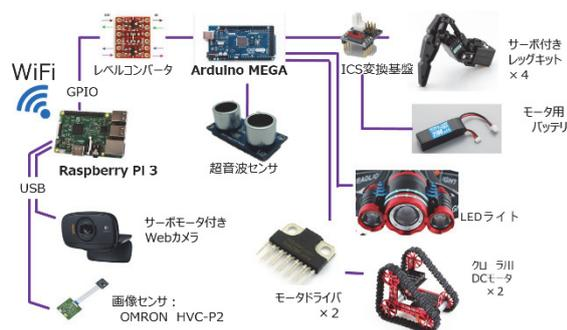
図4 旧型ロボットの構成図
