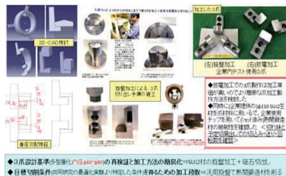
図2 CAD 検証による三つ爪開発手順と爪の仕様図
