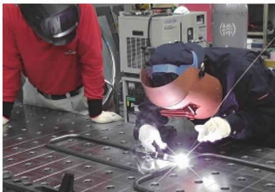
図5 TIG溶接作業風景
