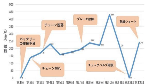
図 12 試験走行評価結果
