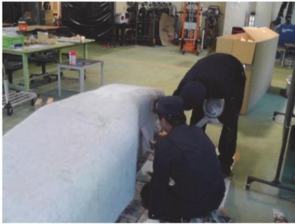
図 8 カーボンカウル製作風景
