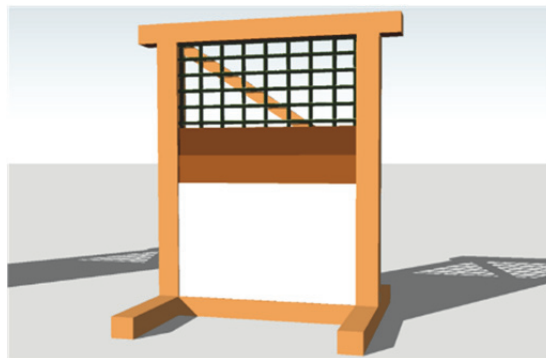
図11 漆喰壁塗り④ 漆喰壁上塗り
