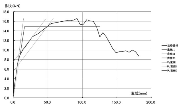
図 4 完全弾塑性モデルによる降伏耐力・終局耐力 (幅 1820mm 繊維密度 0.70g/cm 3 の MDF の場合)
