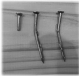
写真5 試験終了後の釘の変形の状況
