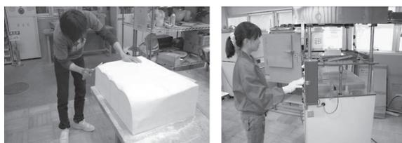
図4・図5 発泡体及び真空成形によるモデル制作
