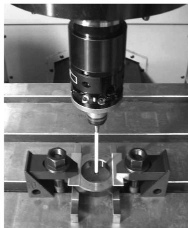
図21 リングゲージによるキャリブレーション
