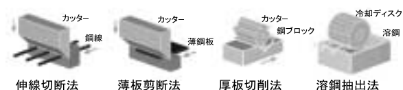
図1 スチールファイバの製造方法
