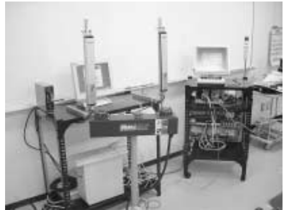
図4 試作したプレス機械シミュレータ(左)と制御盤(右)
