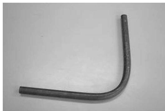
写真2 油圧配管用パイプ
