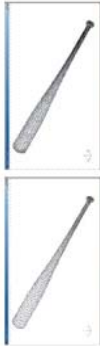
金属バットのFEM解析モデル(シェル要素) 金属バットのFEM解析モデル(ソリッド要素)
