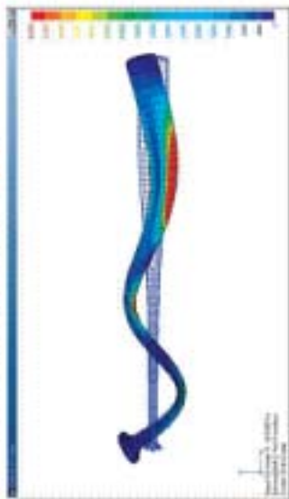
シェル要素による解析結果 (mode11 1434.6[Hz])
