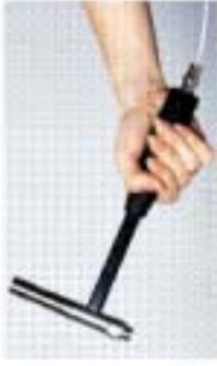
図2-2-2 市販のインパルスハンマの例 (小野測器 GK-3100：エクステンダ装着状態)
