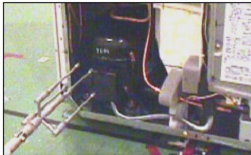
図 5-2-3 音響インテンシティ計測
