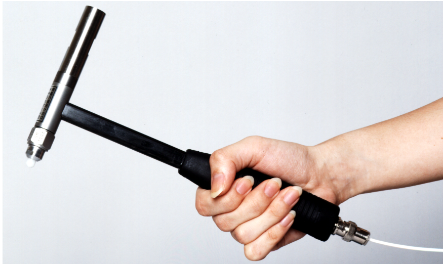
図 2-2-2 市販のインパルスハンマの例 (小野測器 GK-3100 : エクステンダ装着状態)
