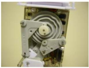
図4-49 簡易2足歩行ロボットの歩行制御用溝カム
