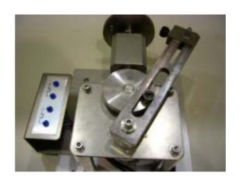
図4-26 早戻り機構(クイック・リターン機構)
