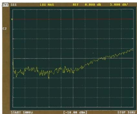
図5 入力端子側の反射特性(例)
