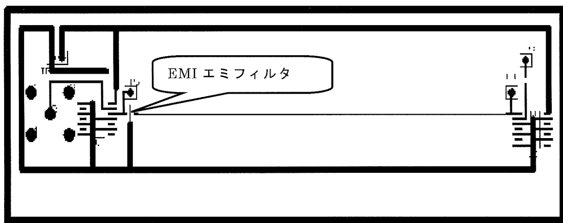
図4 フィルタ付きデジタル伝送路基板のレイアウトパターン
