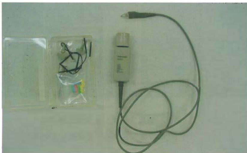
図 8 使用した FET プローブとパーツ
