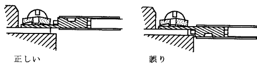
図3-35 1本の圧着端子の配線
