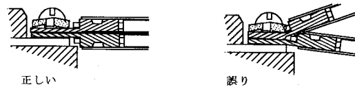
図3-17 2本の圧着端子の配線
