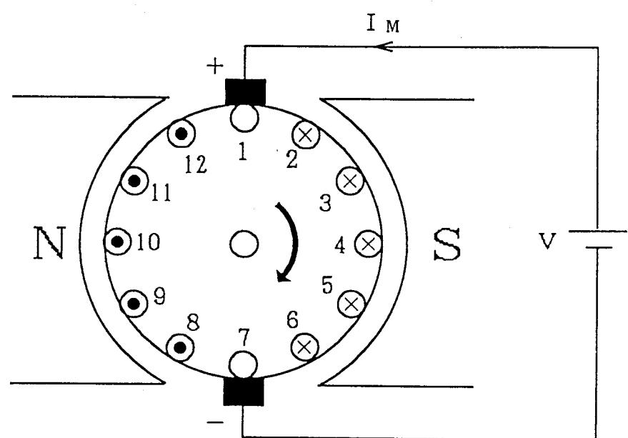
D C モータの基本電磁回路構成
