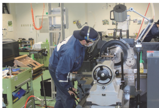
図 4-27 機械種目（普通旋盤作業）
