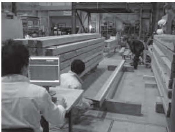
図 17 受入れ検査（音響打撃法による E 測定）
