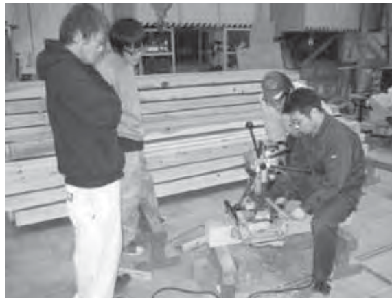
図 25 追掛け大栓継ぎの加工指導
