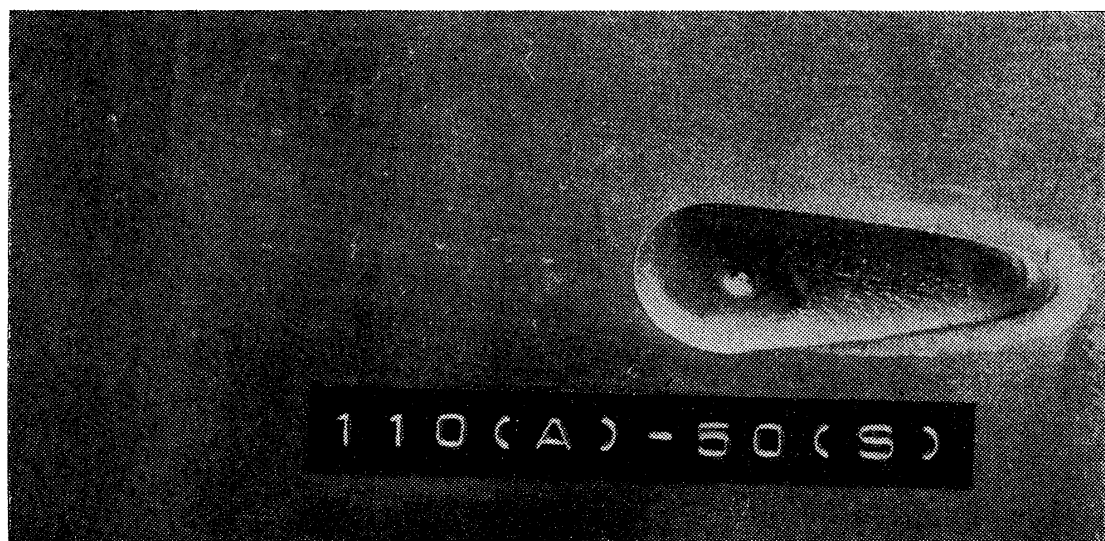
(a) 設定電流 ( I_o )=110A, 溶接速度 (V)=5cm/min
