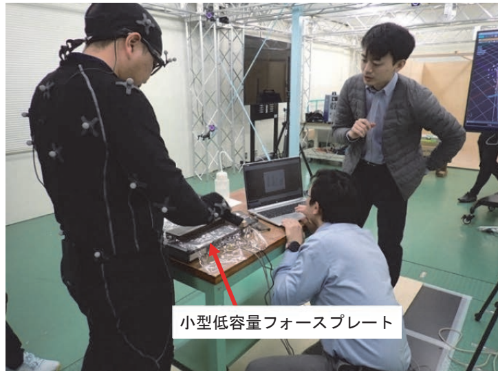
図3-4 のみの裏押し作業時の各種計測の様子
