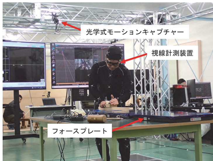
図 3 - 3 かな掛け作業時の各種計測の様子
