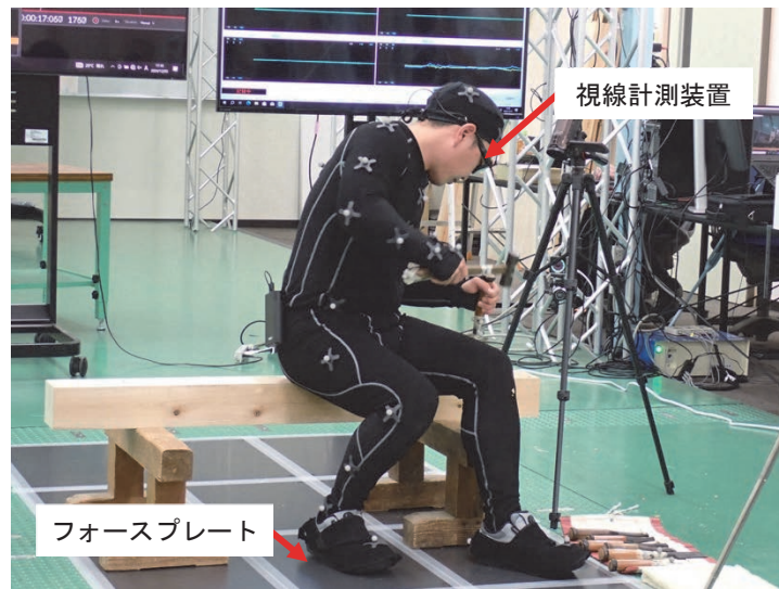
図 3 - 2 ほぞ穴掘り作業時の各種計測の様子
