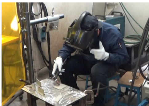
図 25 3D 溶接マスクを使用した溶接風景
