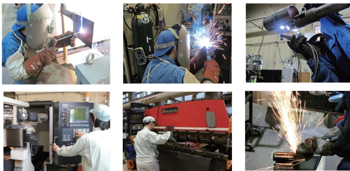
図2-5 実習風景（上：被覆アーク溶接、炭酸ガスアーク溶接、TIG溶接、 下：レーザ加工機、プレスブレーキ作業、グラインダ作業）
