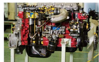
図2-20 自動車製造科 (エンジンカットモデル)
