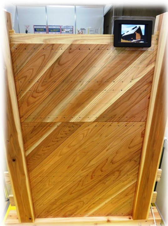
県内スギ板パネル耐力壁（ポリテクカレッジ千葉）
