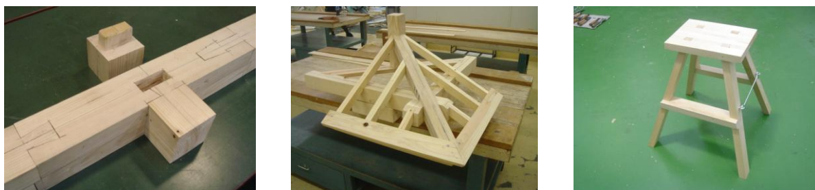
図2-2 訓練課題（左：腰掛け鎌&あり継手 中：棒隅木桁仕口 右：四方転び脚立）
