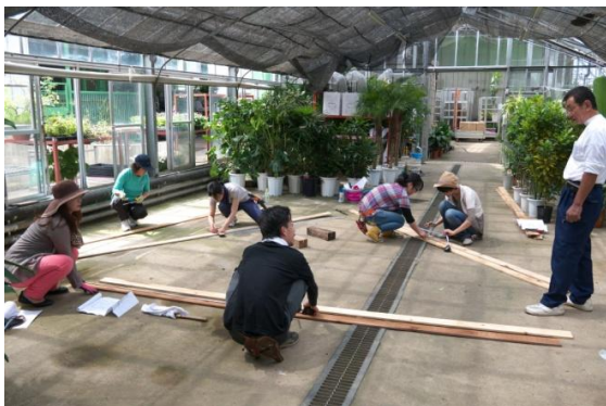
ぬき枠組製作加工の作業
