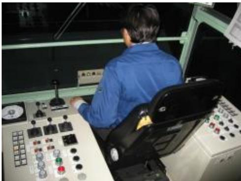
ガントリークレーンシミュレータの内部
