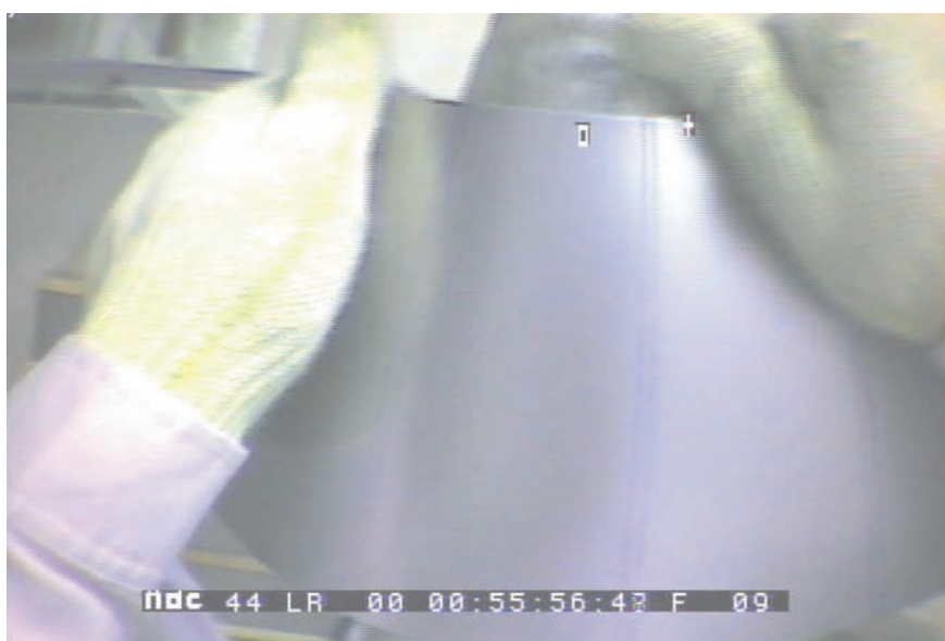
図10-41 アイカメラによる分析（曲線曲げ内径側）
