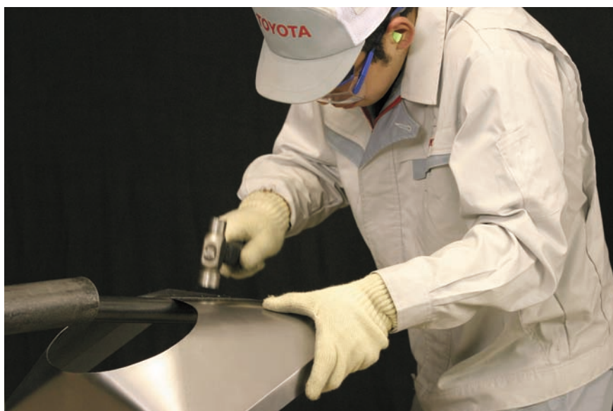
図10-6 一般技能者のベース表側のひずみ取り
