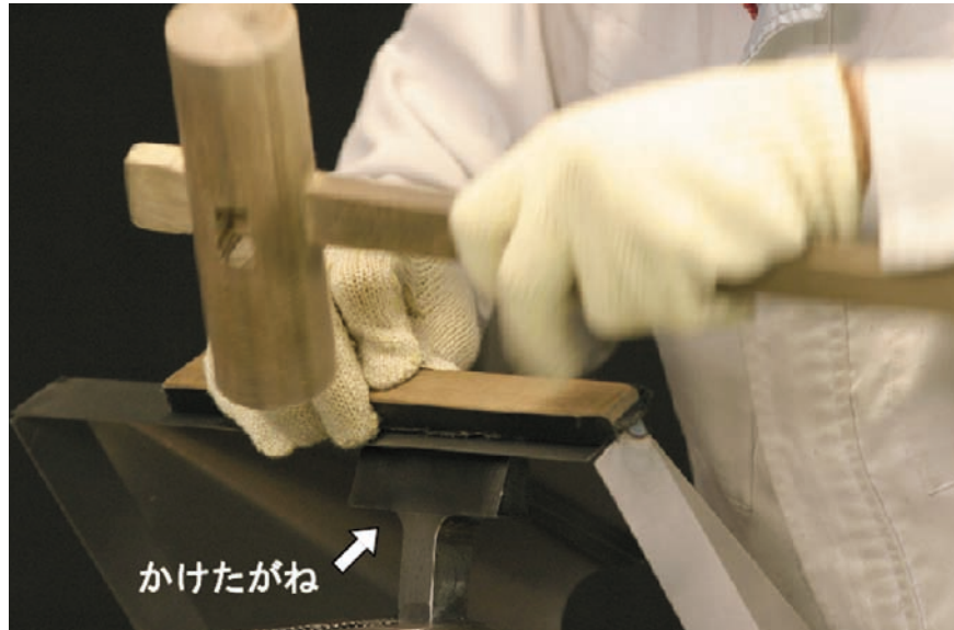
図10-7 溶接部分の直線曲げ
