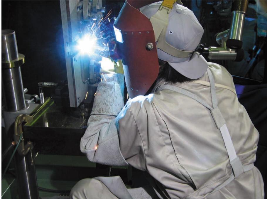
図6 - 256 一般技能者の12 mm 板横向き姿勢後退法溶接における溶接姿勢
