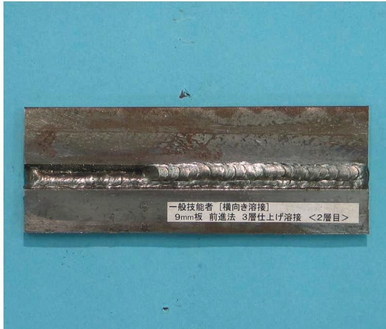
図6 - 241 一般技能者の9mm板の前進法溶接の2層目までの溶接結果
