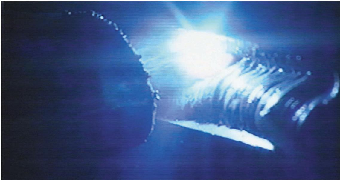
図 6 - 259 一般技能者の12 mm 板横向き姿勢後退法 2 層目 2 パス目溶接のトーチの状況
