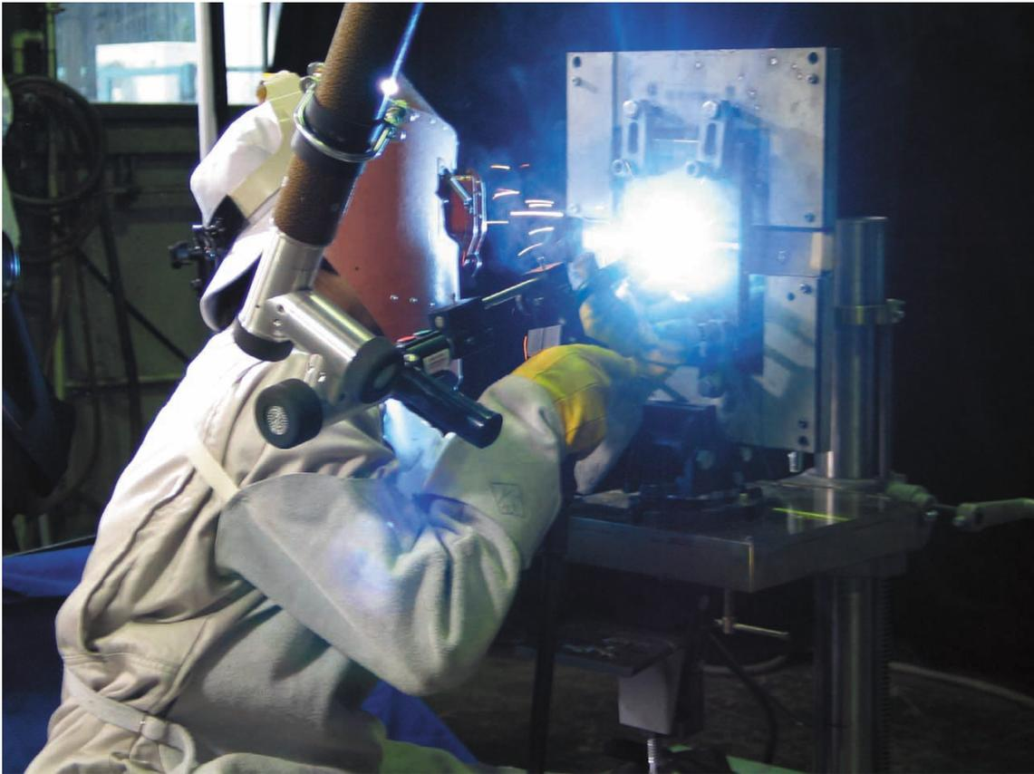
図6 - 214 一般技能者の9mm 板前進法溶接における溶接姿勢
