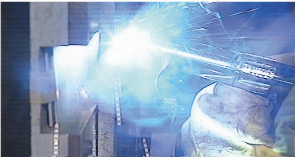
図 6 - 216 一般技能者の 9 mm 板前進法 1 層目溶接におけるトーチの状況
