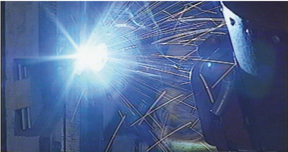
図 6 - 218 一般技能者の 9 mm 板前進法 2 層目 1 パス目溶接におけるトーチの状況
