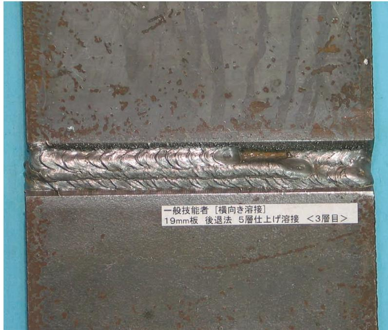
図6 - 284 一般技能者の19 mm 板の後退法溶接の3層目までの溶接結果
