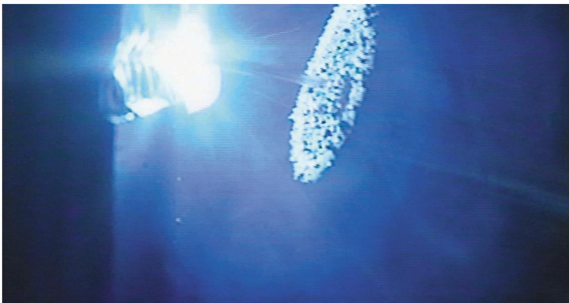
図 6 - 250 一般技能者の12 mm 板前進法 3 層目 1 パス目溶接におけるトーチの状況
