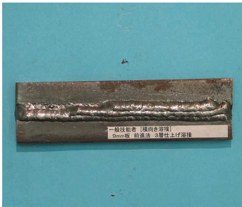
図6 - 242 一般技能者の9mm板の前進法溶接の最終溶接結果
