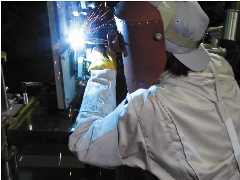
**図6 - 228 一般技能者の9 mm 板横向き姿勢後退法溶接における溶接姿勢**
