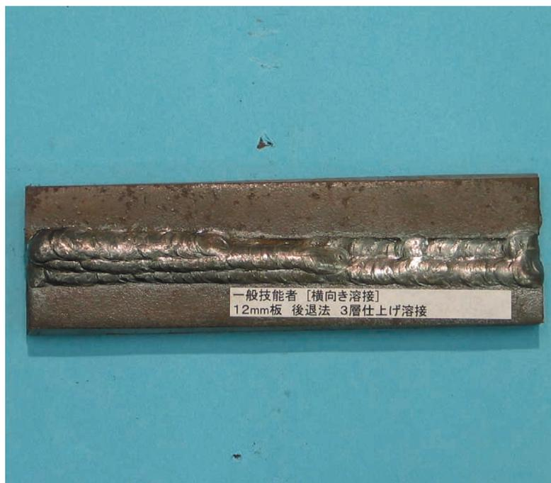
図6 - 270 一般技能者の12 mm 板の後退法溶接の最終溶接結果
