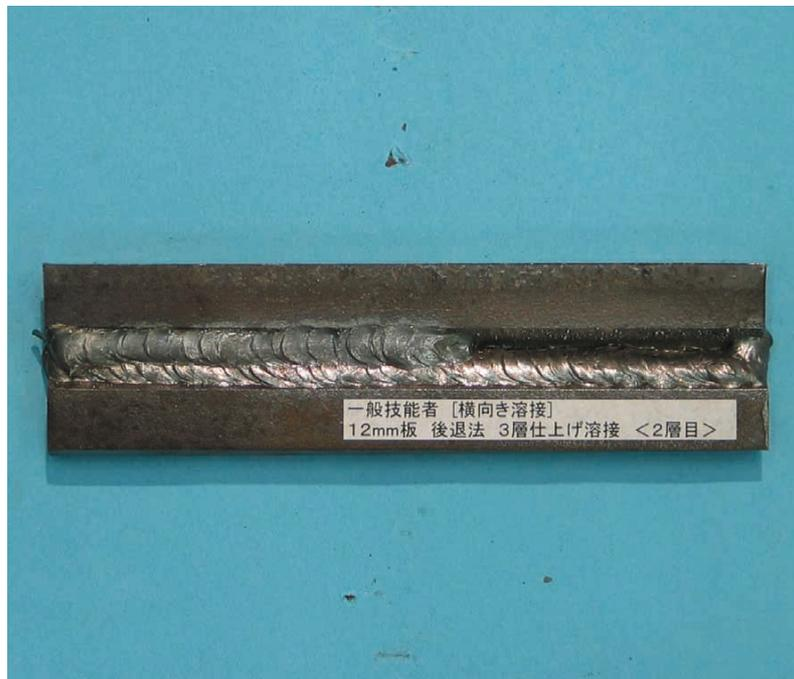
図6 - 269 一般技能者の12 mm 板の後退法溶接の2層目までの溶接結果
