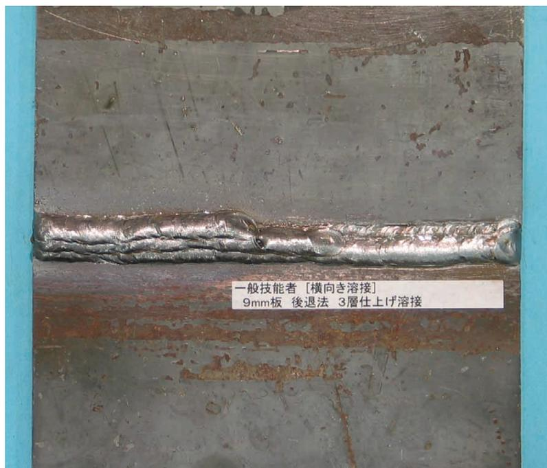
図6-244 一般技能者の9mm板の後退法溶接の最終溶接結果
