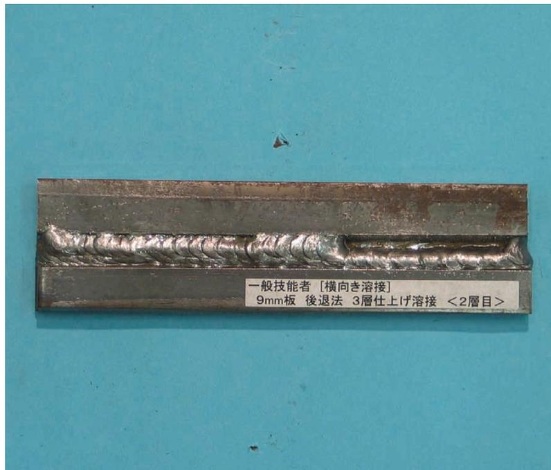
図6-243 一般技能者の9mm板の後退法溶接の2層目までの溶接結果
