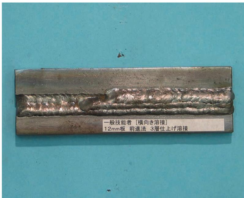
図6 - 268 一般技能者の12 mm 板の前進法溶接の最終溶接結果
