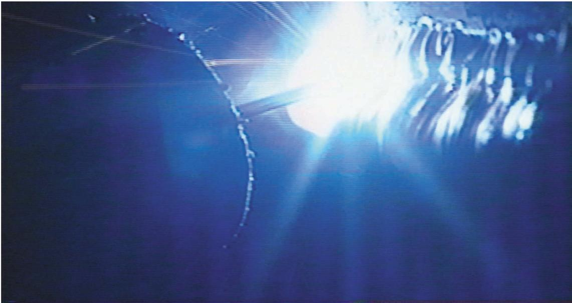
図6 - 237 一般技能者の9 mm 板横向き姿勢後退法3層目2パス目溶接のトーチの状況
