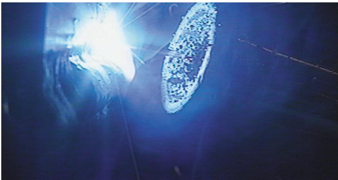
図 6 - 254 一般技能者の 12 mm 板前進法 3 層目 3 パス目溶接におけるトーチの状況
