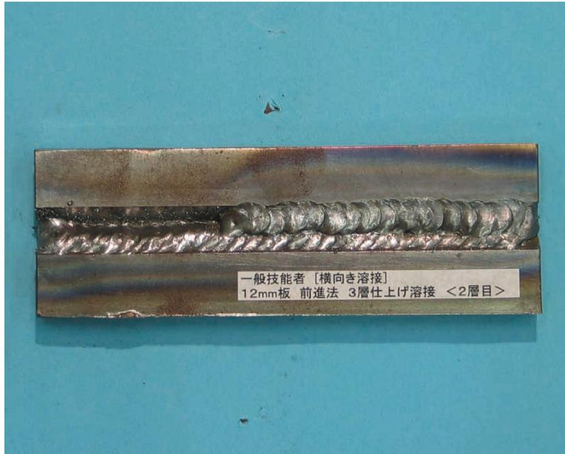
図6 - 267 一般技能者の12 mm 板の前進法溶接の2層目までの溶接結果
