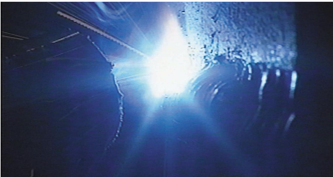
図 6 - 265 一般技能者の12mm 板横向き姿勢後退法 3 層目 3 パス目溶接のトーチの状況
