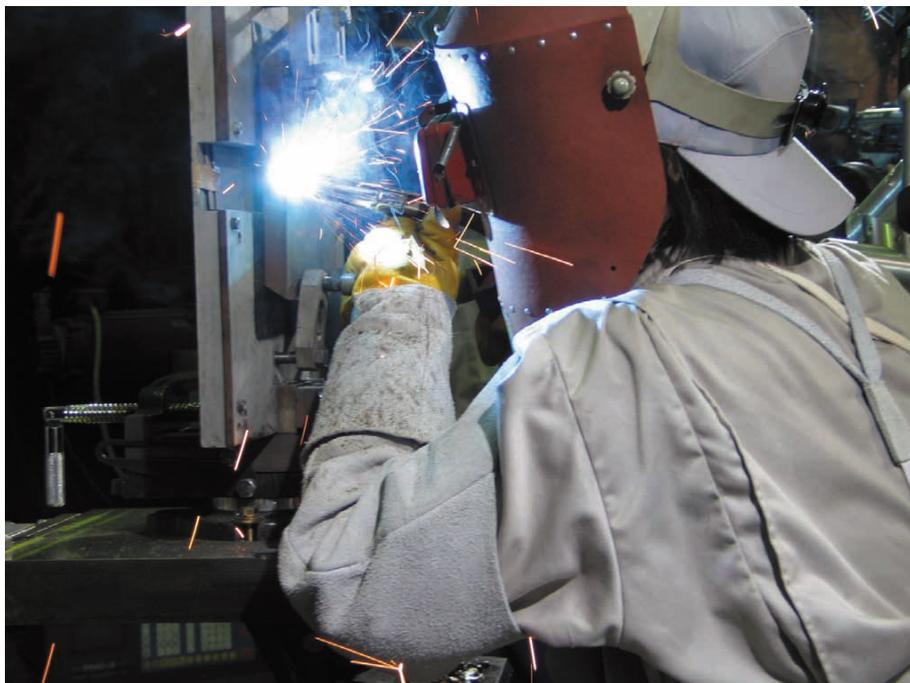
図 6 - 277 一般技能者の19 mm 板横向き姿勢後退法溶接における溶接姿勢
