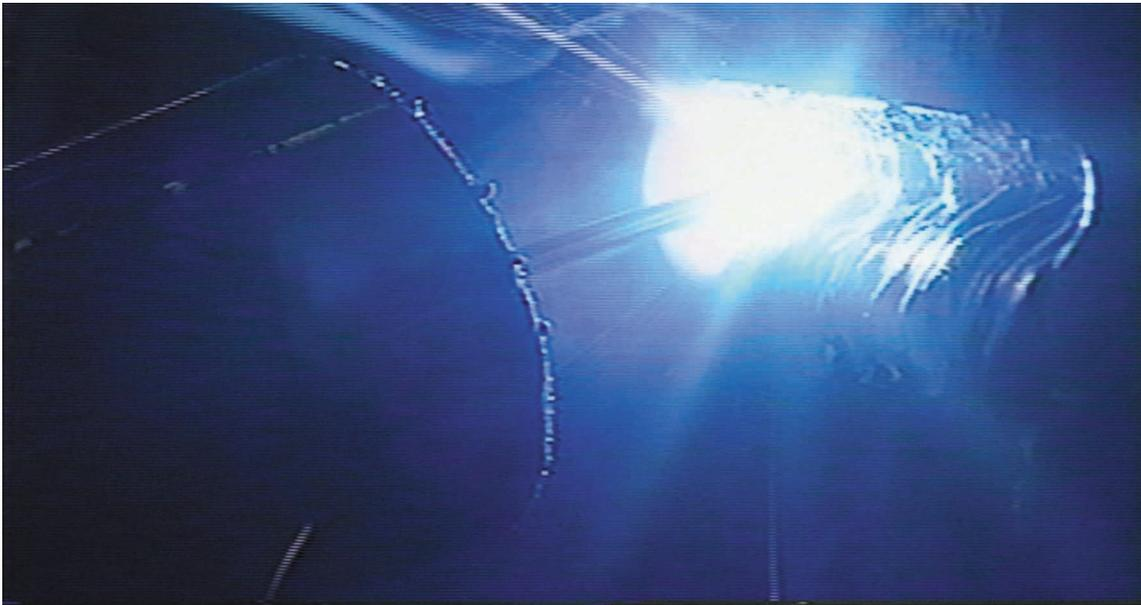
図 6 - 233 一般技能者の 9 mm 板横向き姿勢後退法 2 層目 2 パス目溶接のトーチの状況
