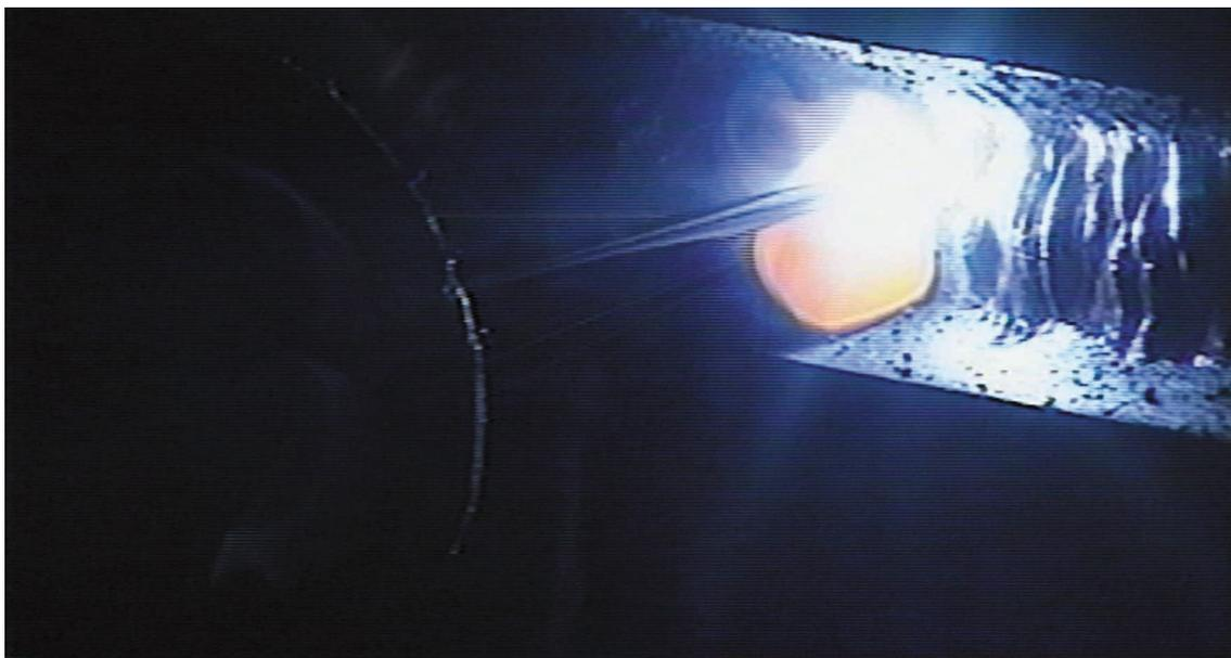
図 6 - 231 一般技能者の 9 mm 板横向き姿勢後退法 2 層目 1 パス目溶接のトーチの状況
