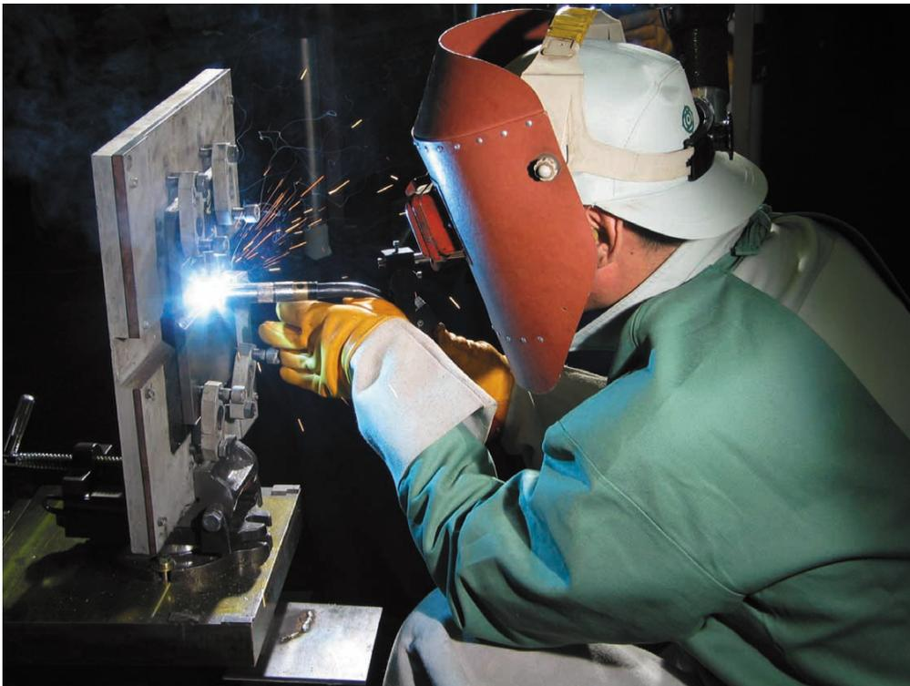
図6 - 154 高度熟練技能者の12 mm 板横向き姿勢後退法溶接における溶接姿勢
