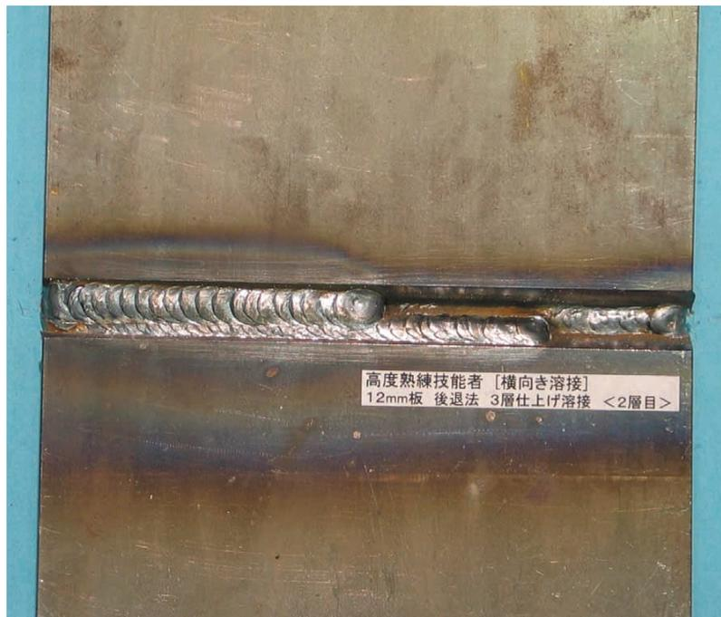
図6 - 175 高度熟練技能者の12 mm 板の後退法溶接の2層目までの溶接結果
