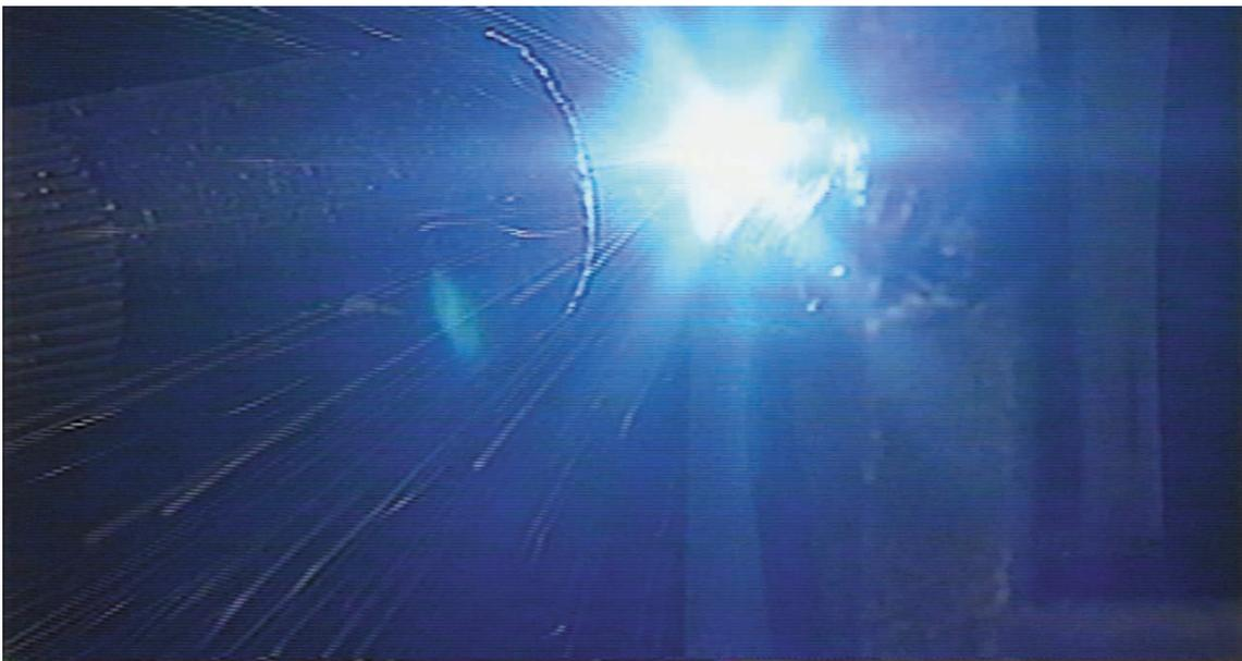
図 6 - 163 高度熟練技能者の12 mm 板横向き姿勢後退法 3 層目 2 パス目溶接のトーチの状況
