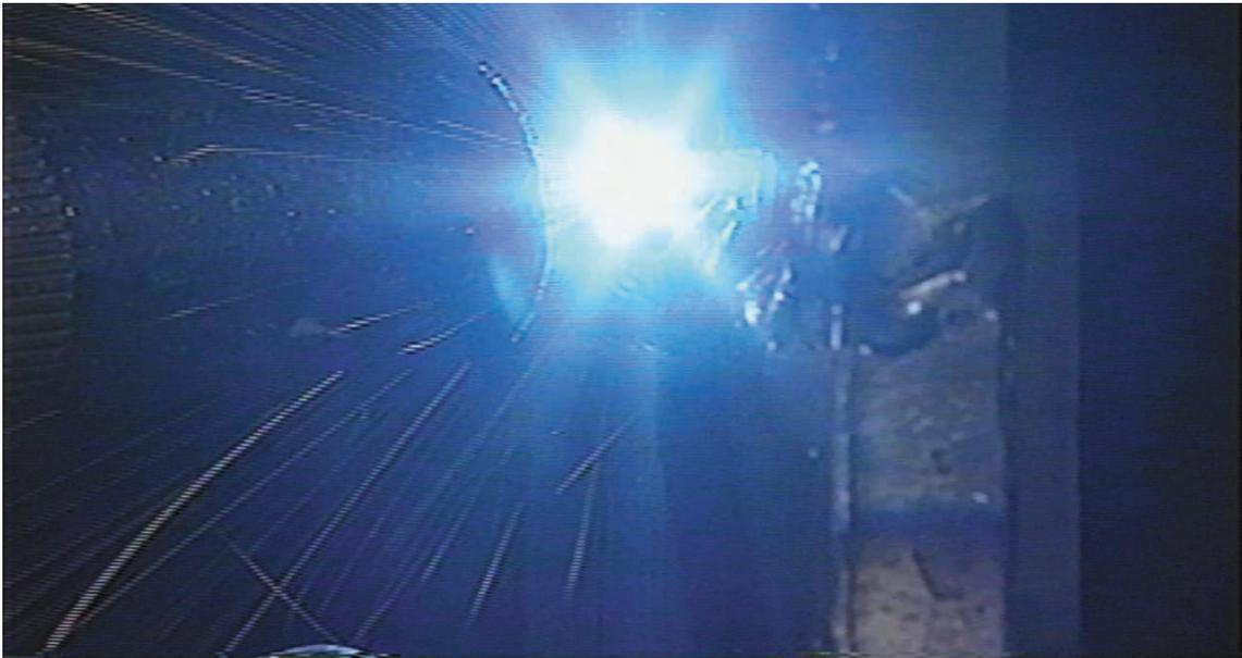
図 6 - 171 高度熟練技能者の 12 mm 板横向き姿勢後退法 3 層目 3 パス目溶接 ( 3 層目 3 パス仕上げ溶接 ) のトーチの状況
