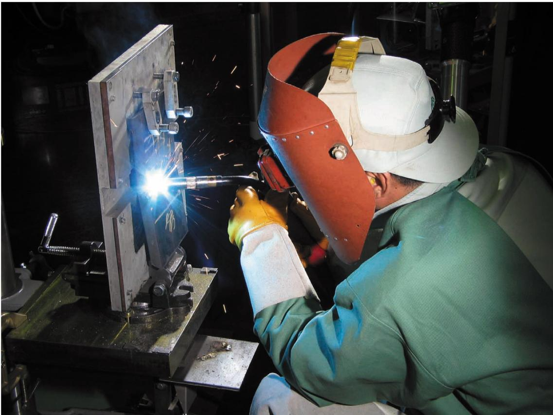
図6 - 189 高度熟練技能者の19 mm 板横向き姿勢後退法溶接における溶接姿勢
