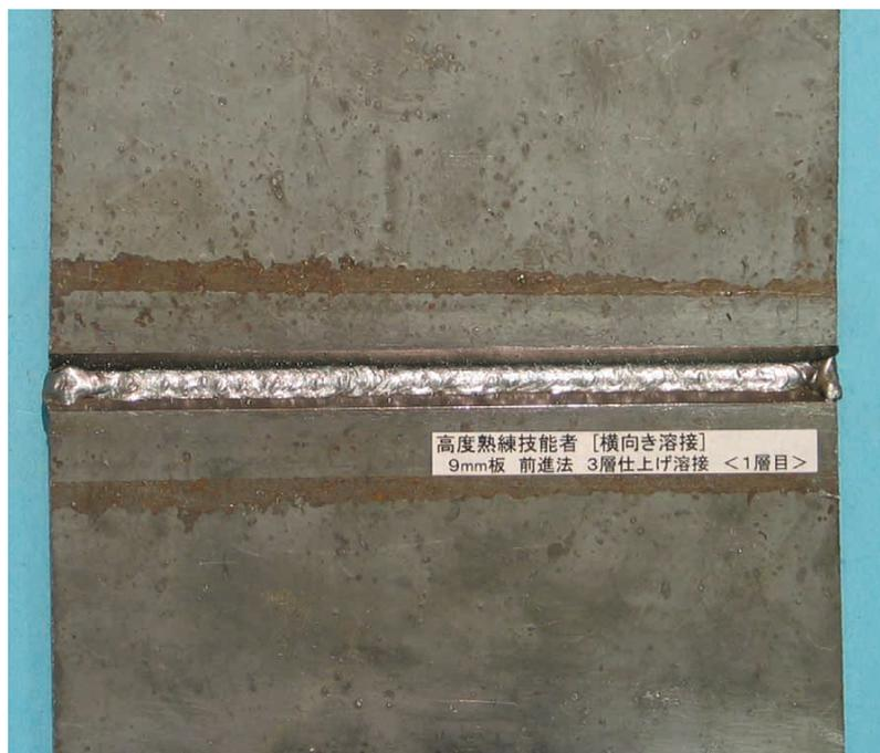
図6-133 高度熟練技能者の9mm板の前進法溶接の1層目の溶接結果
