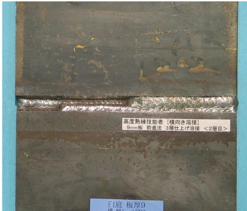
図6 - 134 高度熟練技能者の9 mm 板の前進法溶接の2層目までの溶接結果
