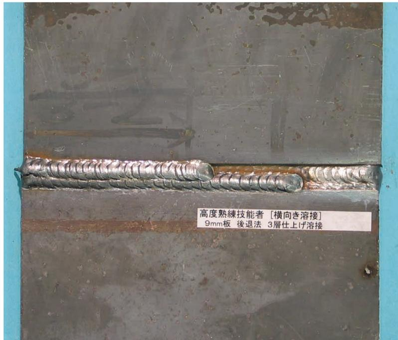
図6 - 137 高度熟練技能者の9 mm 板の後退法溶接の最終溶接結果
