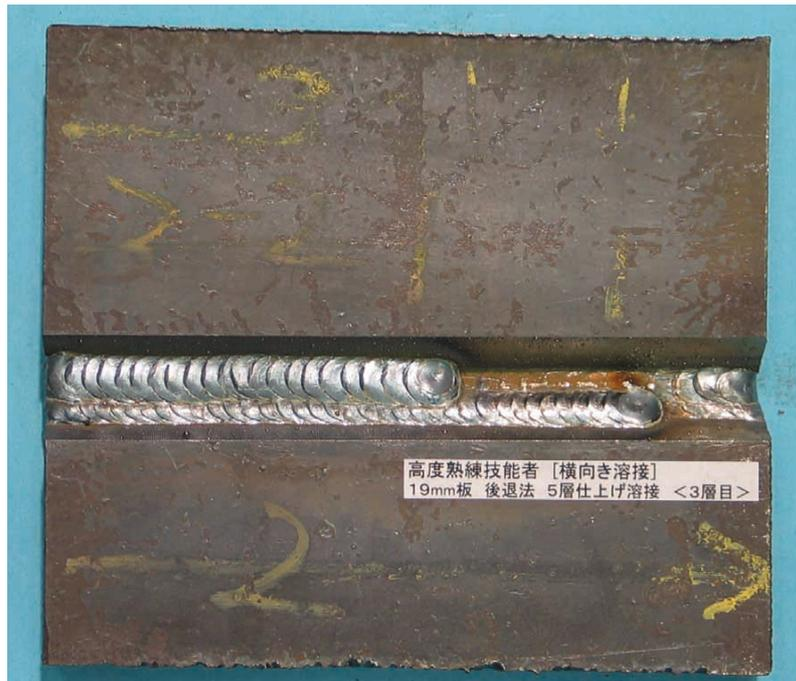
図6 - 203 高度熟練技能者の19 mm 板の後退法溶接の3層目までの溶接結果
