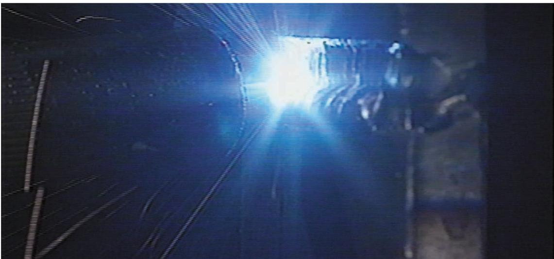
図6 - 169 高度熟練技能者の12 mm 板横向き姿勢後退法3層目2パス目溶接（3層目3パス仕上げ溶接）のトーチの状況
