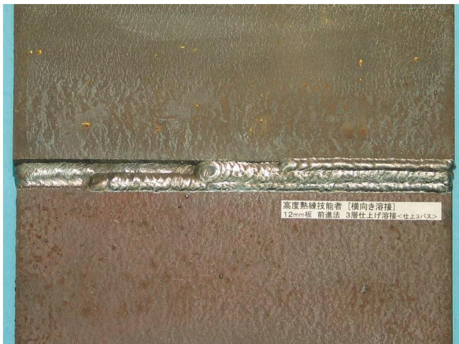
図6 - 174 高度熟練技能者の12mm板の前進法溶接の最終溶接結果
