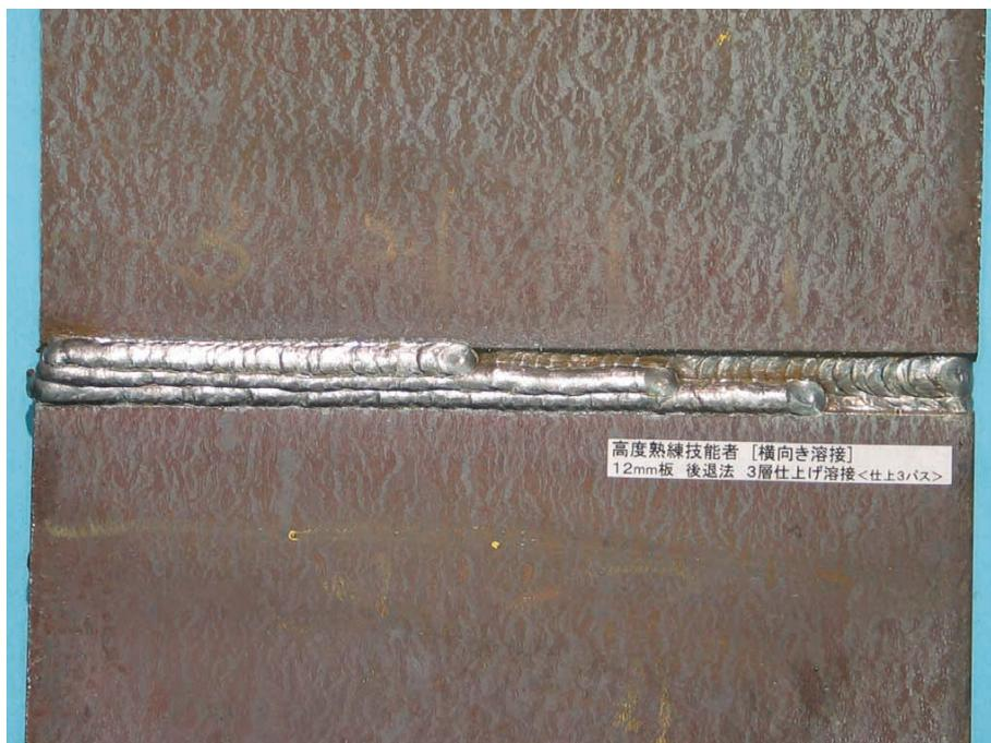
図 6 - 176 高度熟練技能者の12 mm 板の後退法溶接の最終溶接結果
