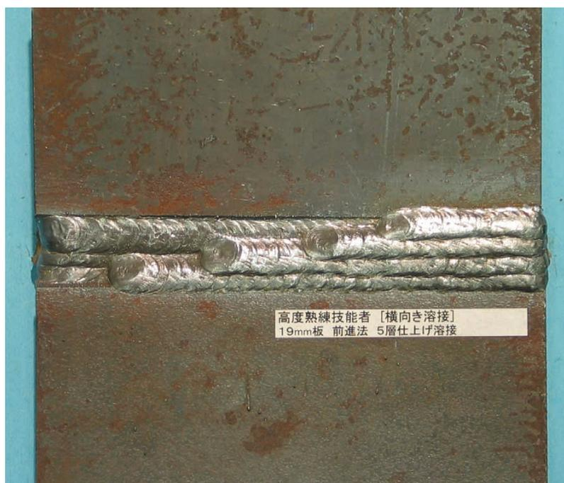
図 6 - 202 高度熟練技能者の19 mm 板前進法溶接の最終溶接結果
