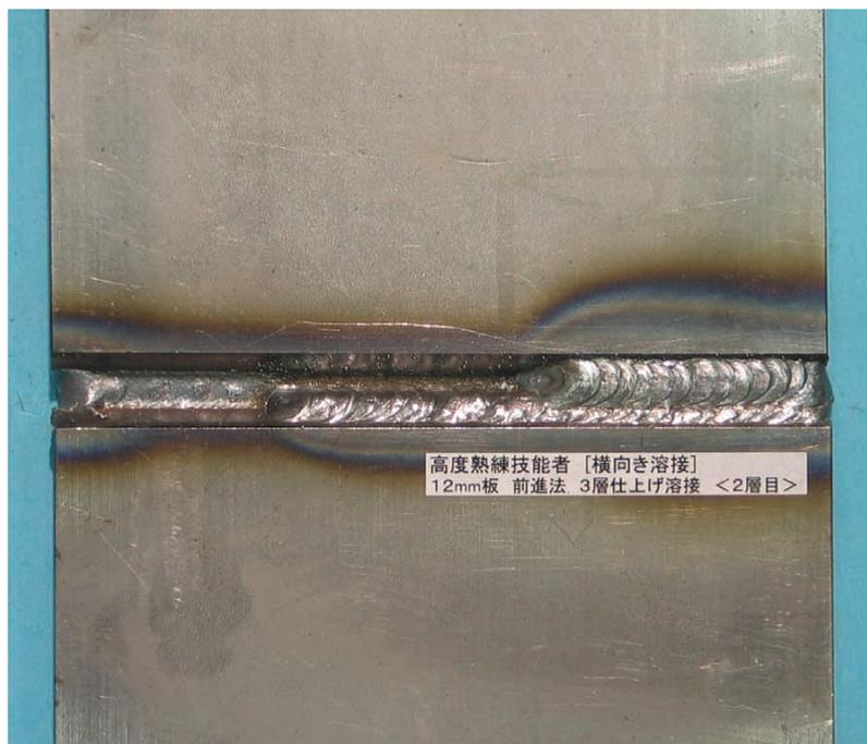
図6 - 173 高度熟練技能者の12 mm 板の前進法溶接の2層目までの溶接結果
