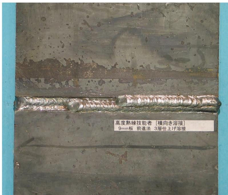
図6 - 135 高度熟練技能者の9 mm 板の前進法溶接の最終溶接結果
