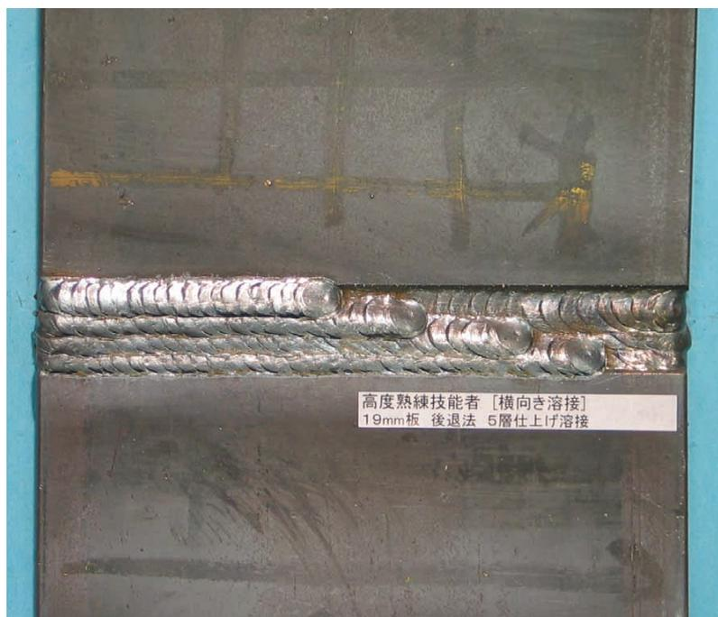
図6 - 204 高度熟練技能者の19 mm 板後退法溶接の最終溶接結果
