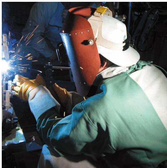
図6 - 139 高度熟練技能者の12 mm 板横向き姿勢前進法溶接における溶接姿勢
