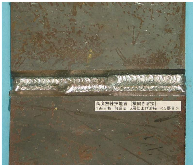
図6 - 201 高度熟練技能者の19 mm 板の前進黨法溶接の3層目までの溶接結果
