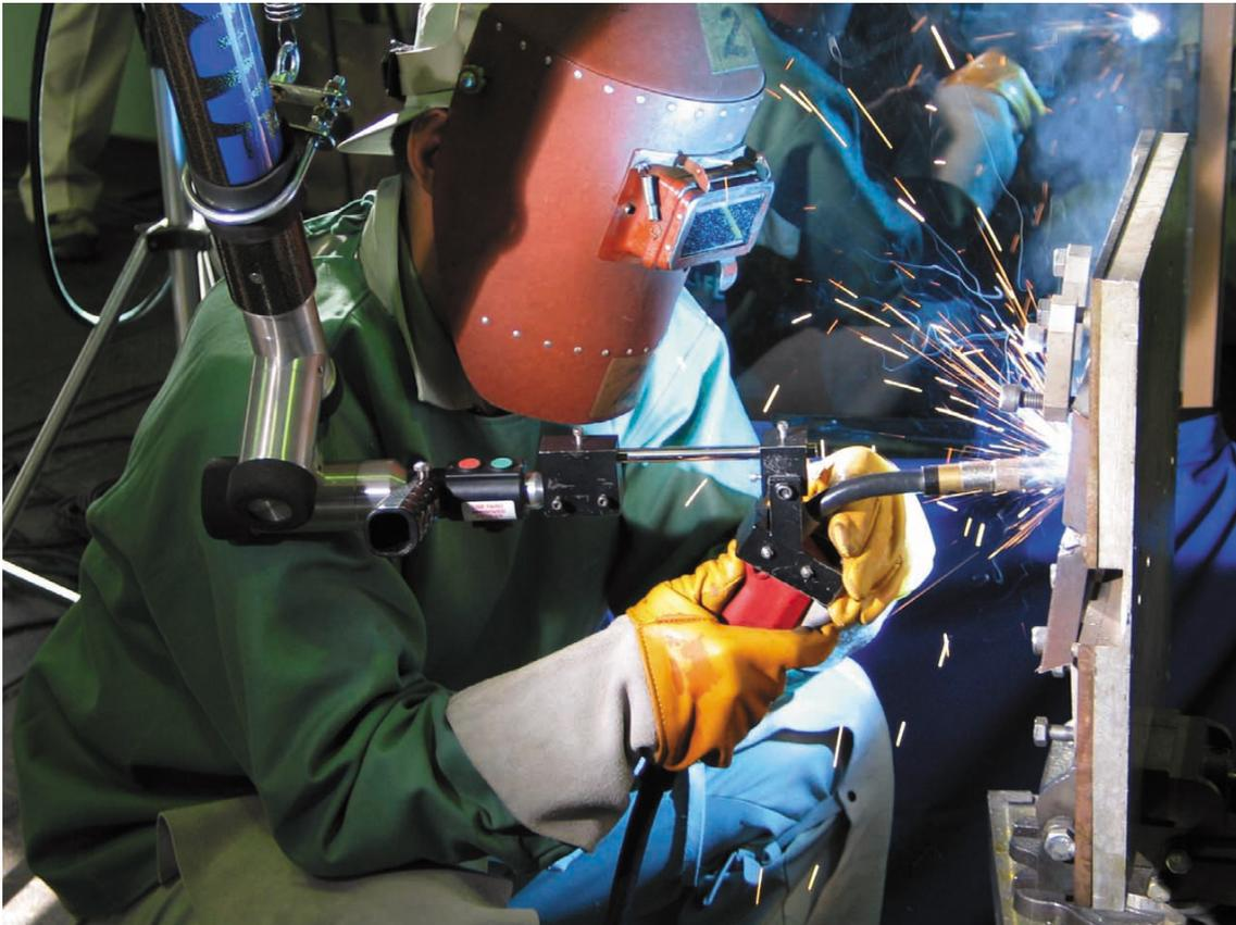
図6 - 177 高度熟練技能者の19 mm 板横向き姿勢前進法溶接における溶接姿勢
