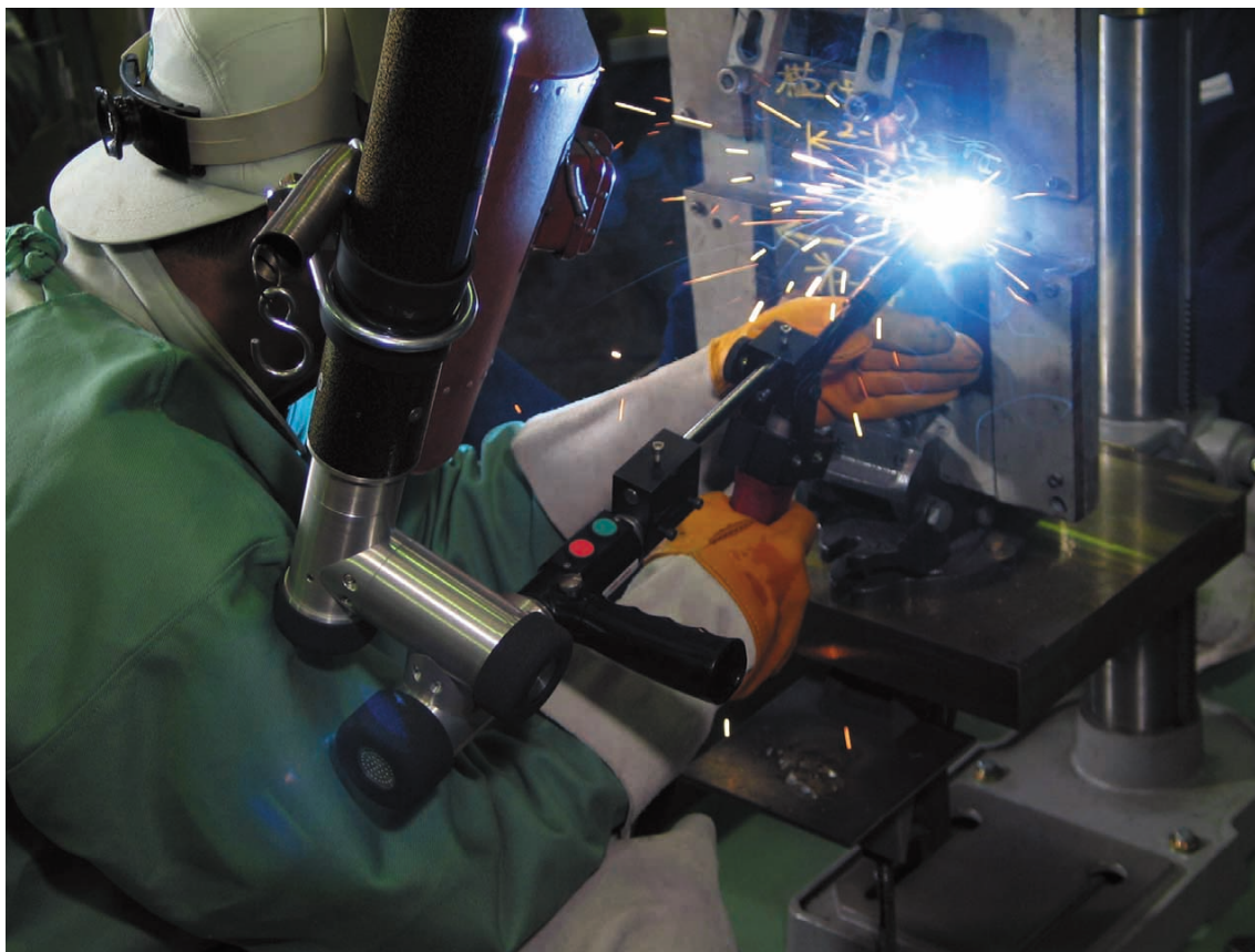
図 6 - 104 高度熟練技能者の 9 mm 板横向き姿勢前進法溶接における溶接姿勢
