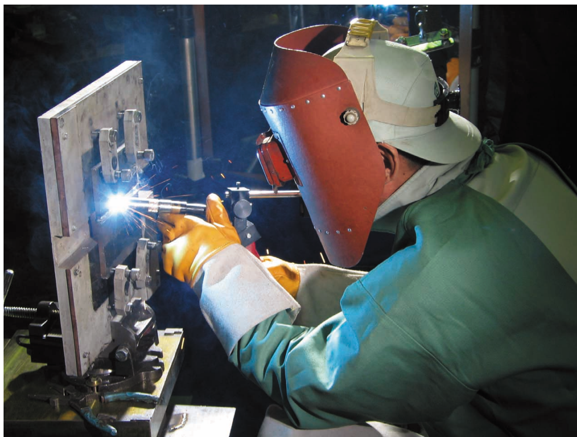
図 6 - 120 高度熟練技能者の 9 mm 板横向き姿勢後退法溶接における溶接姿勢
