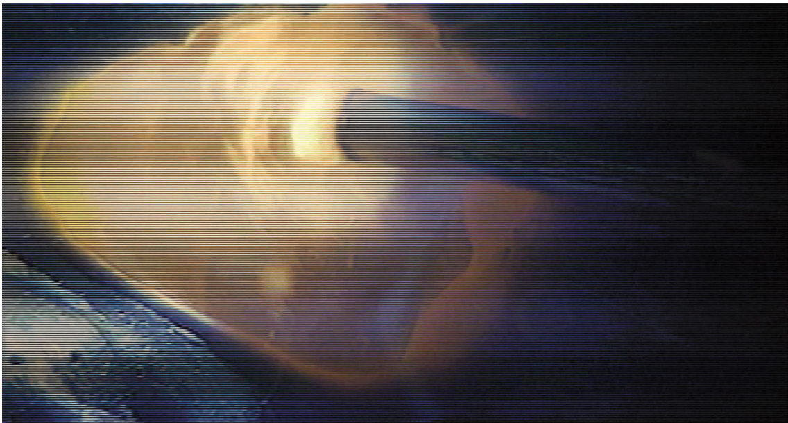
図 6 - 112 高度熟練技能者の 9 mm 板横向き姿勢前進法 2 層目 2 パス目溶接の溶融池の状況
