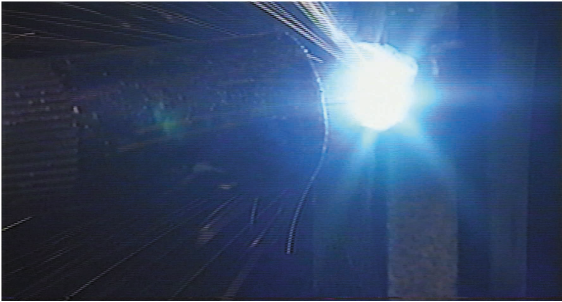
図 6 - 123 高度熟練技能者の 9 mm 板横向き姿勢後退法 2 層目 1 パス目溶接のトーチの状況
