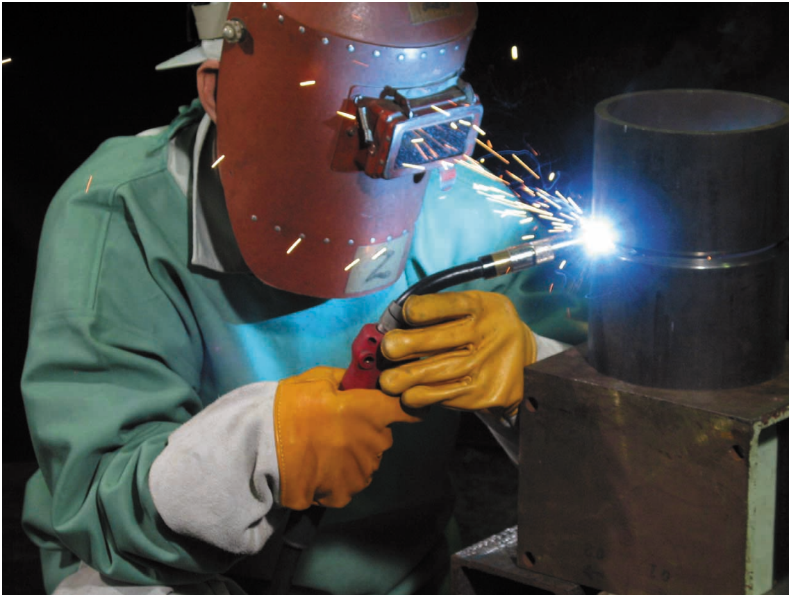
図6 - 100 管の横向き姿勢溶接における身体の姿勢の変化
