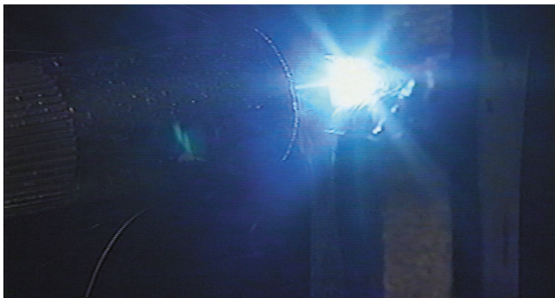
図 6 - 125 高度熟練技能者の 9 mm 板横向き姿勢後退法 2 層目 2 パス目溶接のトーチの状況
