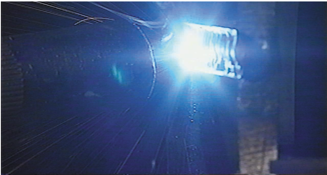
図 6 - 129 高度熟練技能者の 9 mm 板横向き姿勢後退法 3 層目 1 パス目溶接のトーチの状況
