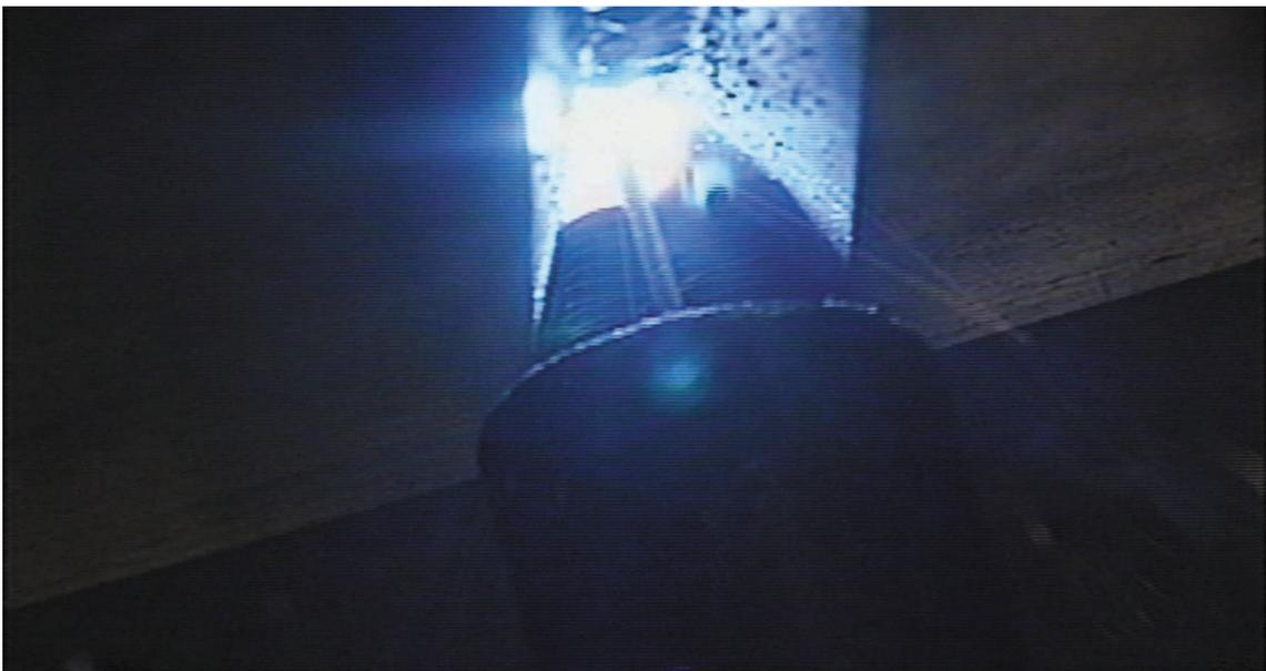
図6 - 24 高度熟練技能者の12 mm 板立て向き姿勢2層目溶接（4層仕上げ溶接）におけるトーチの状況
