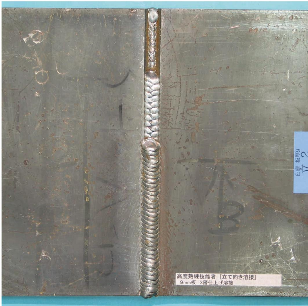
図6-16 高度熟練技能者の9mm板立て向き姿勢溶接の最終溶接結果
