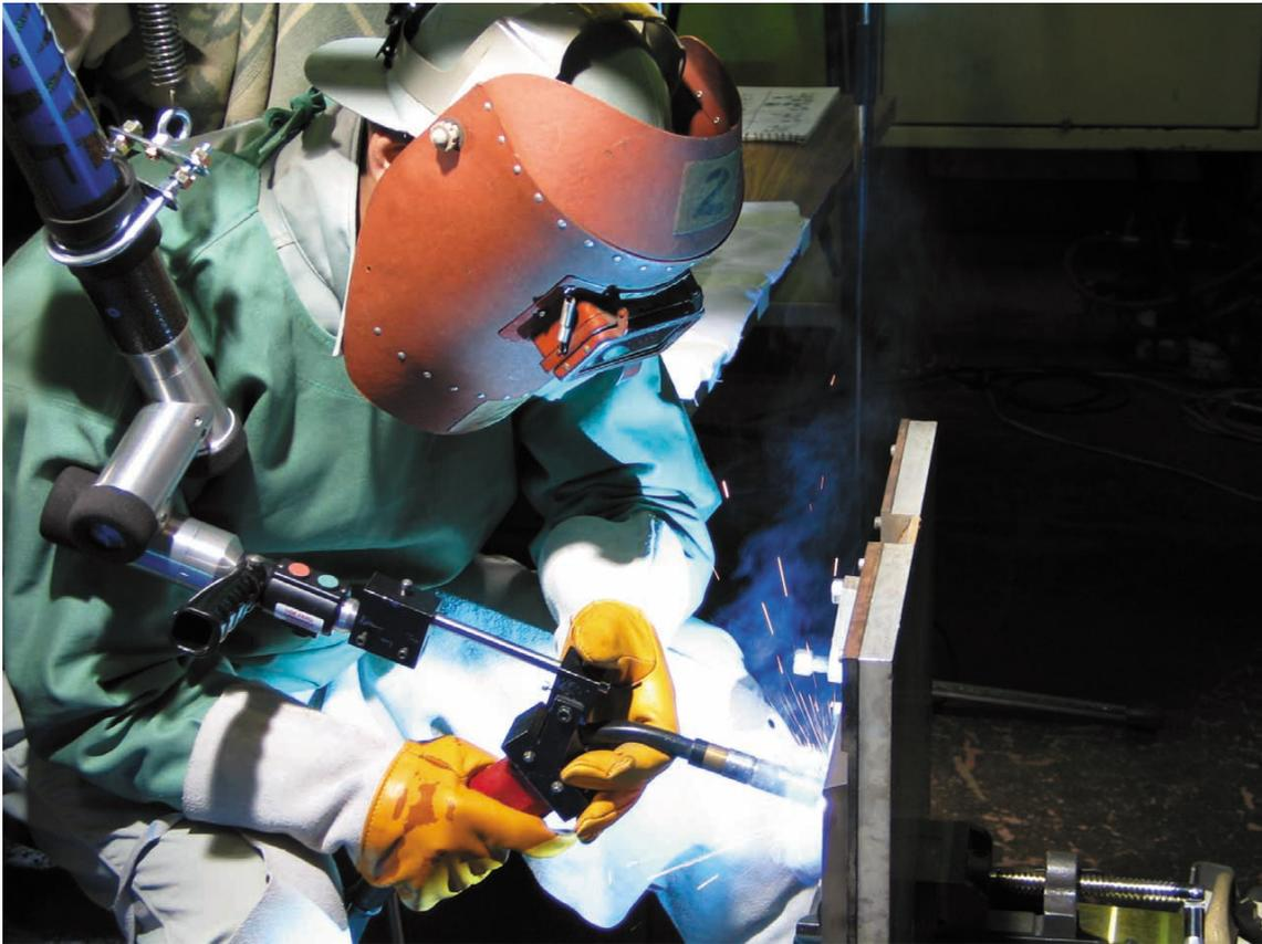
図6 - 37 高度熟練技能者の19 mm 板立て向き姿勢溶接における溶接姿勢
