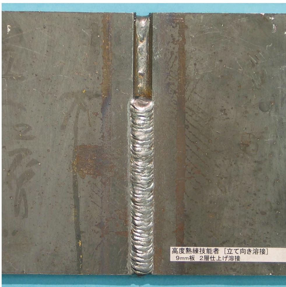
図 6 - 21 高度熟練技能者の 9 mm 板立て向き姿勢溶接 (2 層仕上げ溶接) の最終溶接結果
