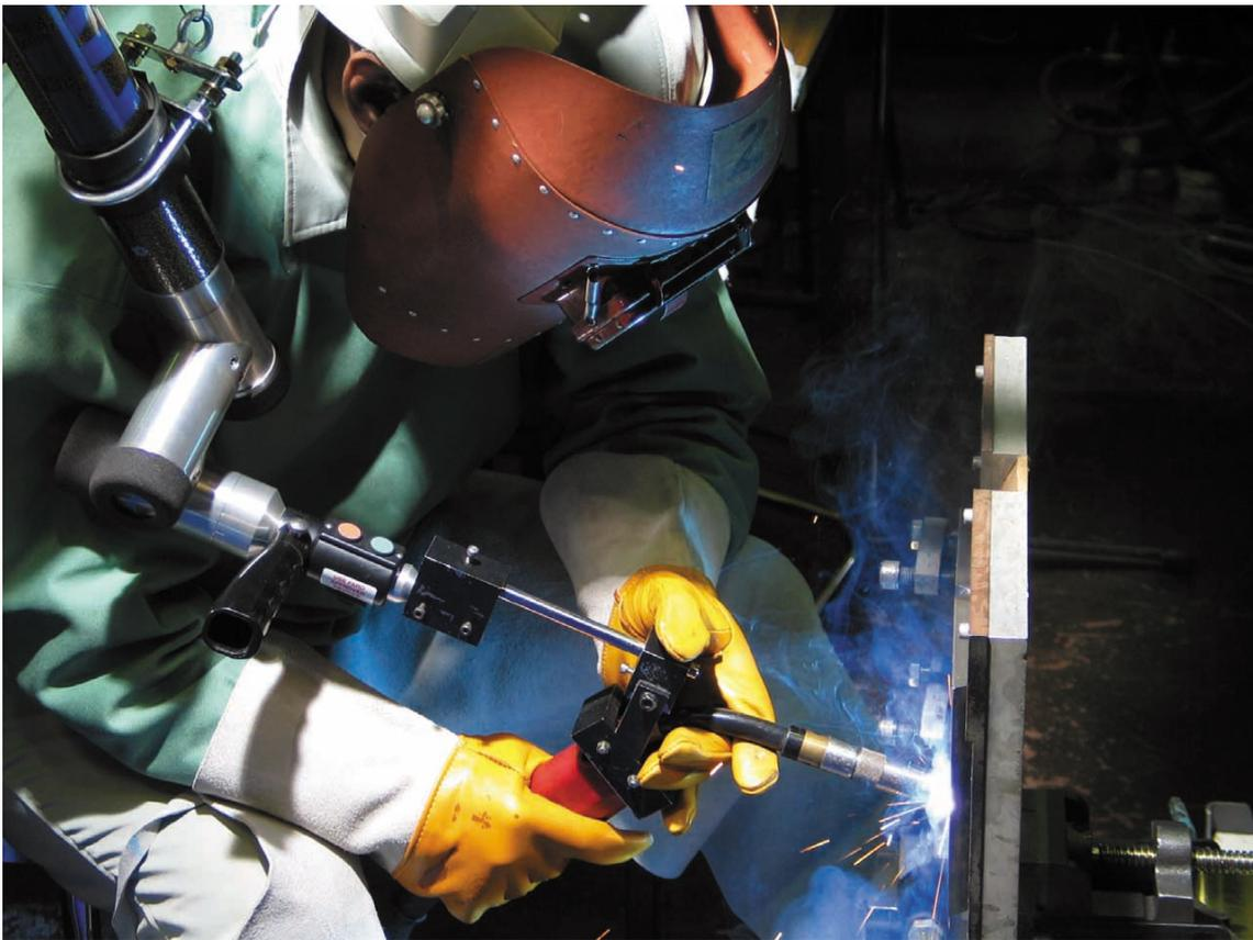
図6 - 23 高度熟練技能者の12 mm 板立て向き姿勢溶接における溶接姿勢
