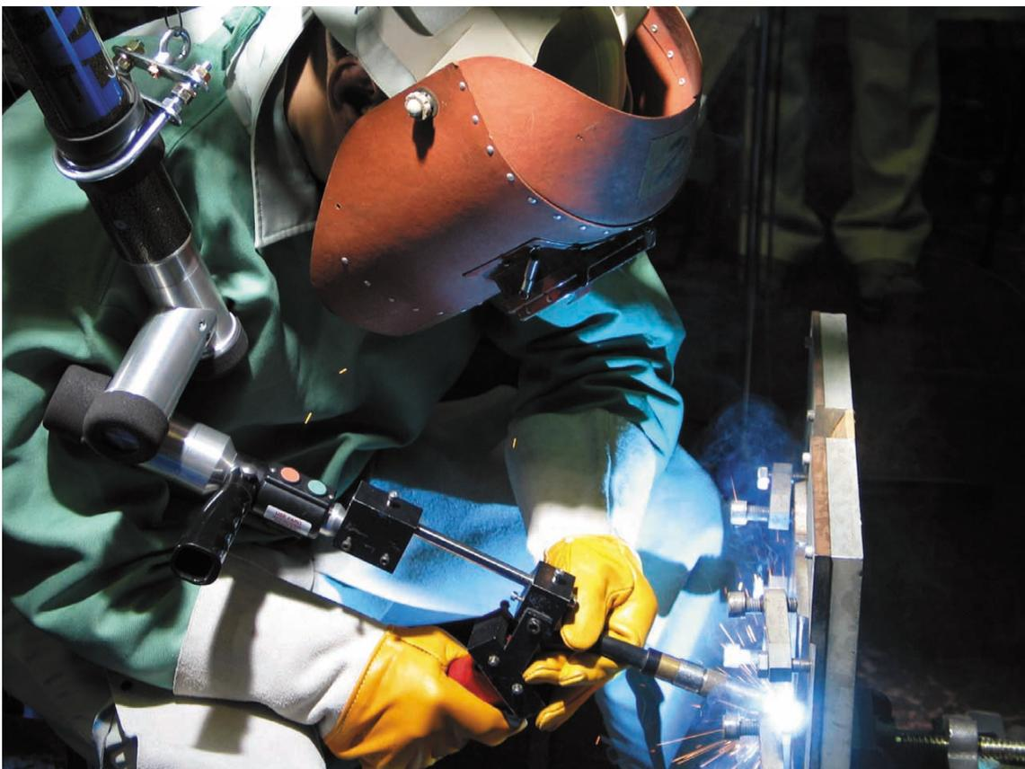
図 6 - 18 高度熟練技能者の 9 mm 板立て向き姿勢溶接(2 層仕上げ溶接)における溶接姿勢
