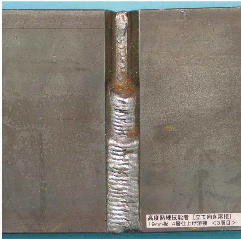
図6 - 45 高度熟練技能者の19 mm 立て向き姿勢溶接の3層目までの溶接結果
