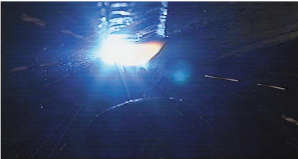
図 6 - 13 高度熟練技能者の 9 mm 板立て向き姿勢 3 層目溶接におけるトーチの状況
