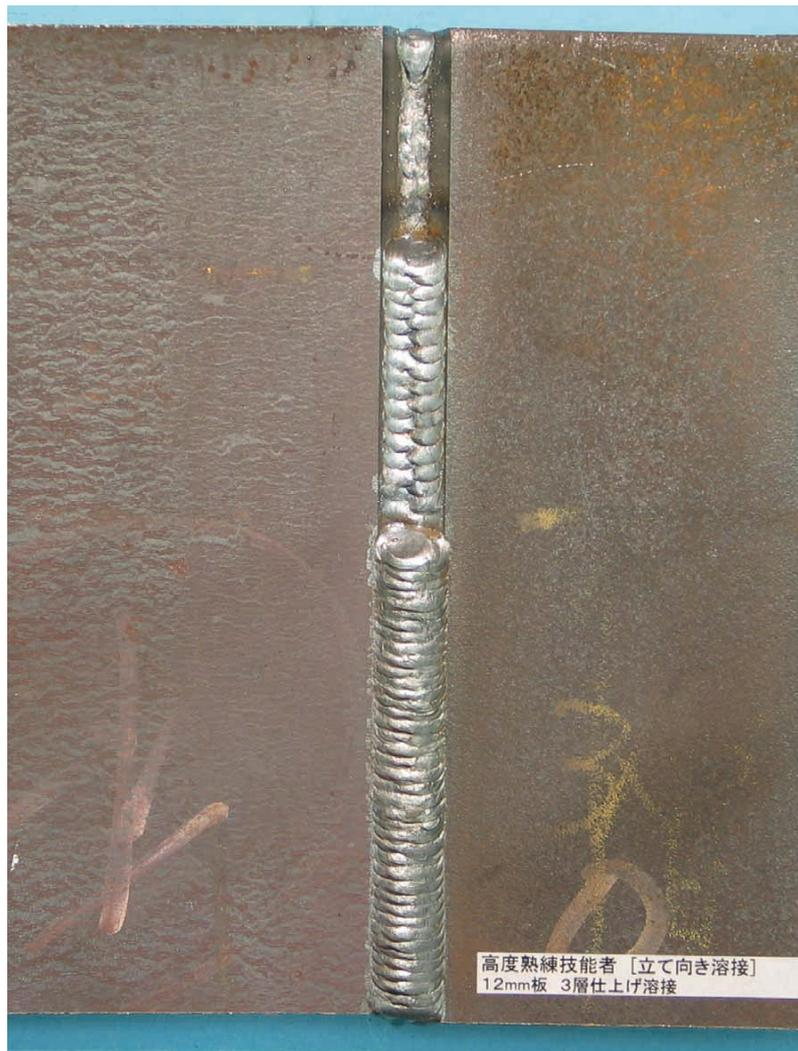
図6 - 36 高度熟練技能者の12 mm 板立て向き姿勢の最終溶接結果
