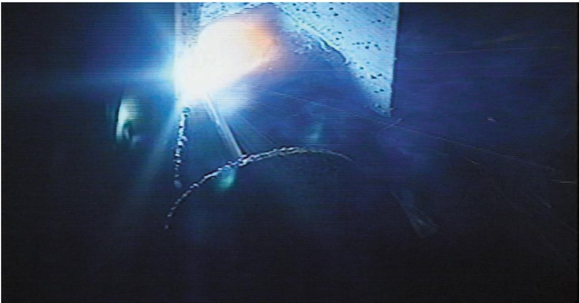
図6 - 38 高度熟練技能者の19 mm 板立て向き姿勢2層目溶接におけるトーチの状況
