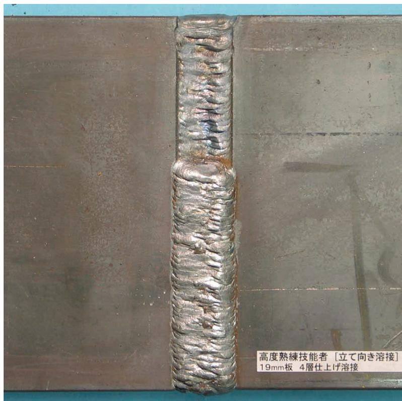
図6 - 46 高度熟練技能者の19 mm 立て向き姿勢溶接の最終溶接結果
