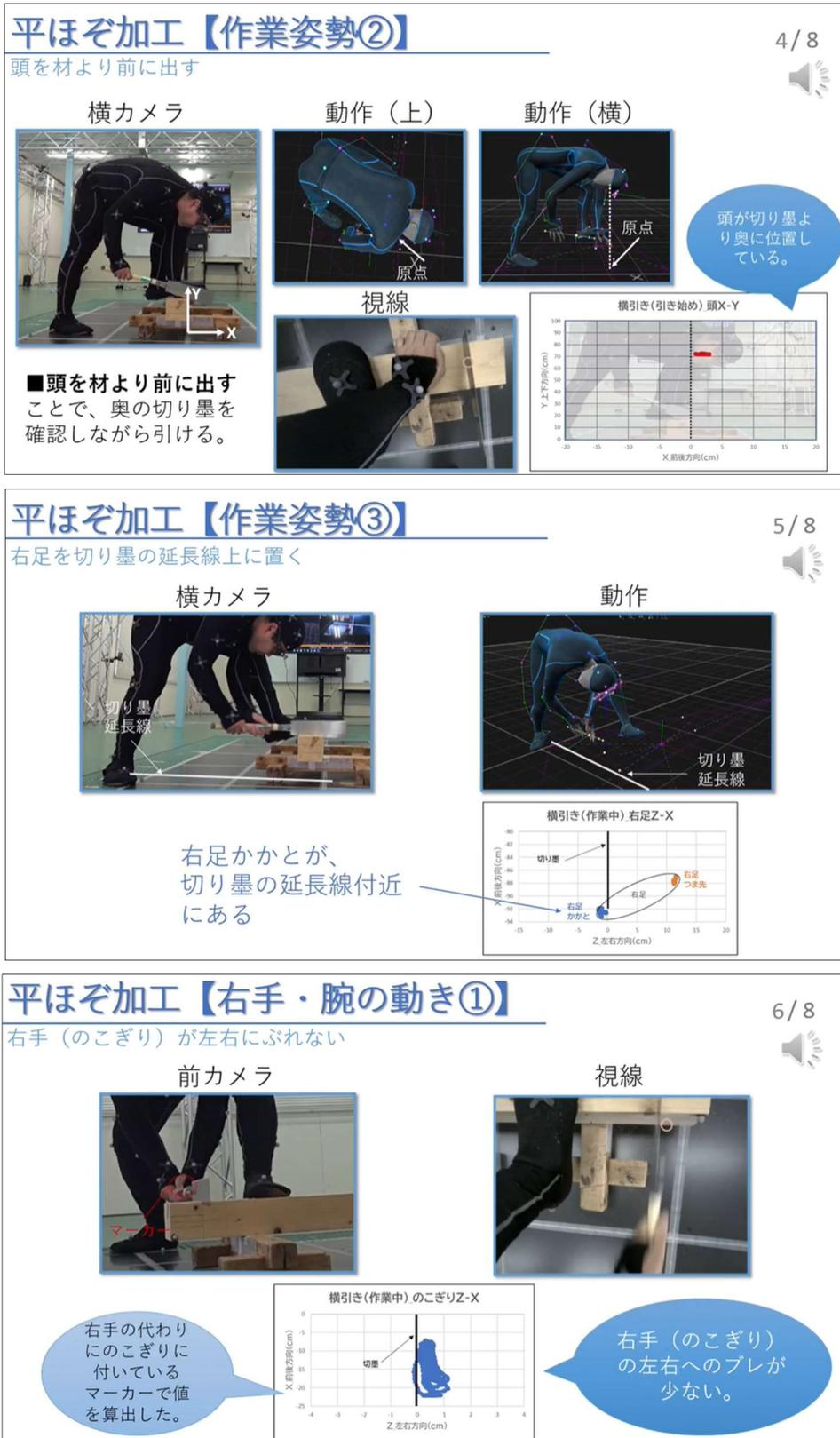
図14 計測データからカンやコツが見える化した動画の一部（建築分野）
