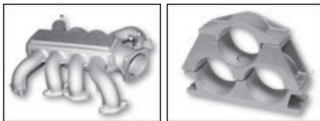
写真 2:アルミニウム金鋳物(左:自動車用マニホールド、右:電気機器用部品) 写真提供:(社)日本鋳造協会
