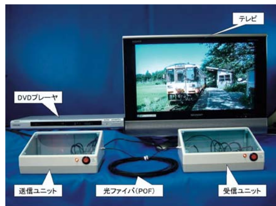
図2 - 2 多重マルチ光伝送ユニットの外観
