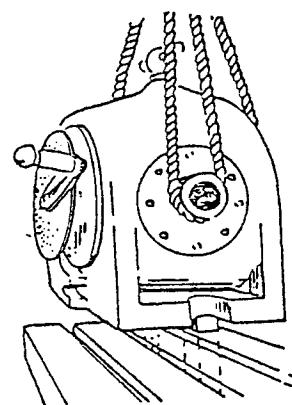
3. Tボルト、ナットおよび座金を用いて割出し盤を固定する。
