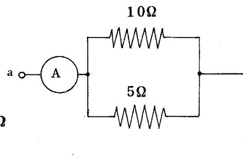
(実験2) 並列抵抗  $r_1$  に流れる電流  $I_1$  がわかっている場合
