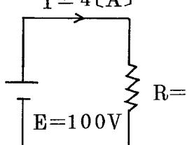
4.  $10 [\Omega]$ の抵抗をもっている電熱器がある。これに  $100 [V]$  の直流電圧を加えたとき電熱器に流れる電流 [A] は。
