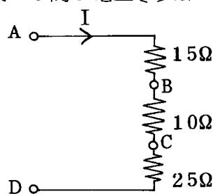
2. 図の回路で A B 間の電圧が 10V であった。 A D 間の電圧はいくらか。
