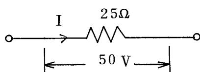
[実験3] 電圧、電流がわかっていて抵抗を求める。
