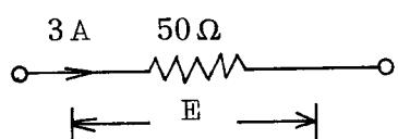
[実験2] 電圧・抵抗がわかっていて電流を求める。
