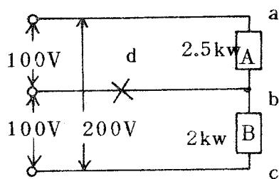
2. 図のような単相三線式線路で中性線が断線すると a b 間の電圧[V]は。
