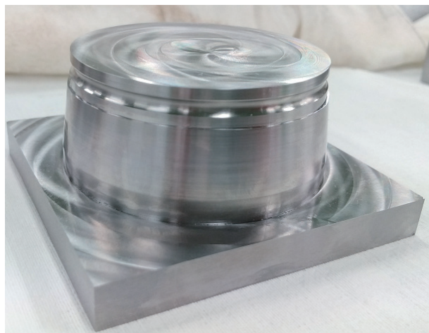
図13 完成した可動側入れ子
